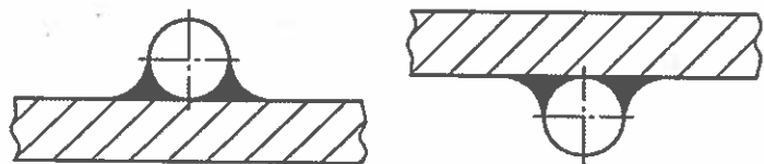
Рис. 7. Форма галтели (закругления) припоя в местах плавного перехода от одной поверхности соединяемых деталей к другой поверхности соединяемых деталей
